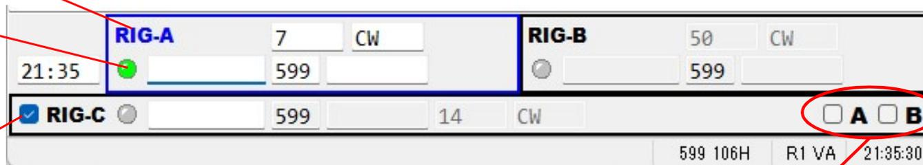
RIG-CをRIG-AとRIG-Bのどちらに組み合わせるかを設定します。両方ON又は両方OFF時は、RIG-A→RIG-B→RIG-Cの順にトグルします。AをチェックONとした場合は、RIG-A→RIG-C→RIG-Aの順にトグルします。BをチェックONとした場合は、RIG-B→RIG-C→RIG-Bの順にトグルします。
